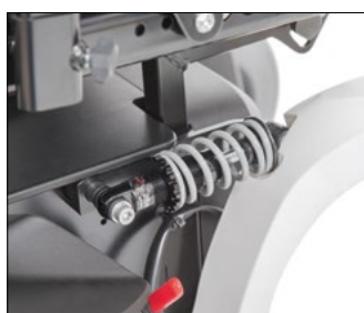
EF001 Амортизаторы поворотных колес
