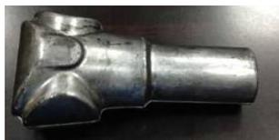
Детали фиксированной спинки 90°, после процессаковки
